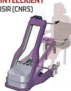
À l'Institut des systèmes intelligents et de robotique, le projet Miras consiste à créer un déambulateur intelligent pour personnes âgées dans le quel la Kinect permet de suivre les mouvements de la personne. Le robot s'y adapte. Des applications dans le domaine de la pédopsychiatrie, fondées sur l'analyse des gestes de l'enfant, sont aussi à l'étude.
