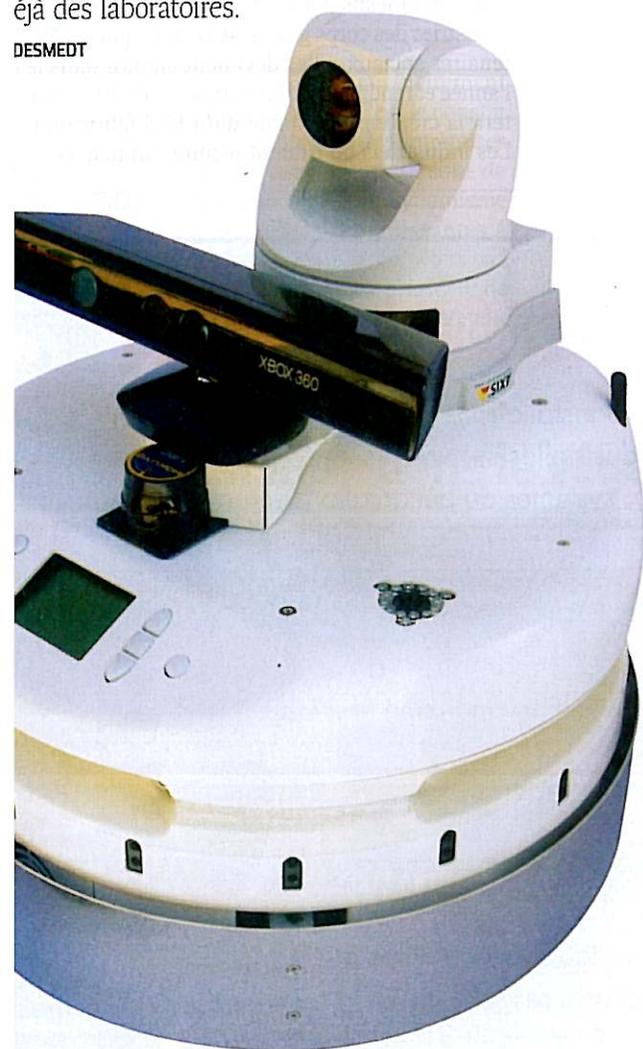
Le boîtier noir de Microsoft est équipé de deux caméras, une infrarouge et d'un microphone. Il est capable de reconnaître les mouvements effectués par un individu et de cartographier l'environnement qui l'entoure.
