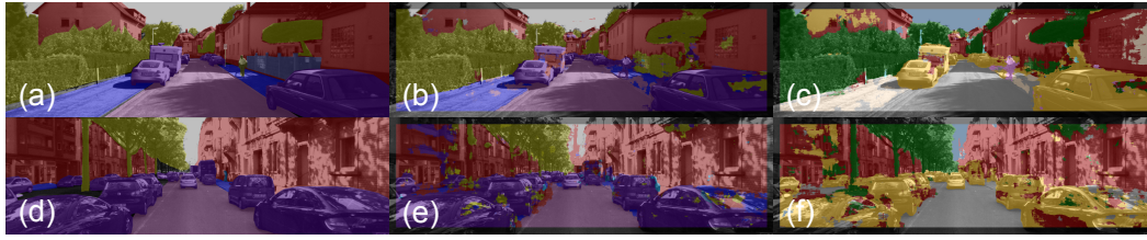
Fig. 5.8.: Exemple de résultats de segmentation sémantique obtenue avec la stratégie AJPC (voir figure 5.1). (a) est la vérité terrain venant de la sous-partie annotée par l'équipe de Ros et al. (b) est le résultat obtenu avec notre stratégie pour l'ensemble d'étiquette de Ros et al. et (c) est le résultat obtenu simultanément sur l'ensemble d'étiquettes utilisé par l'équipe de Kundu et al. De façon identique, (d) est un exemple de vérité terrain provenant de la partie annotée par l'équipe de He et al. , (e) est le résultat obtenu par notre stratégie sur l'ensemble d'étiquettes de He et al. et (f) est le résultat obtenu simultanément sur l'ensemble d'étiquettes de Xu et al.
